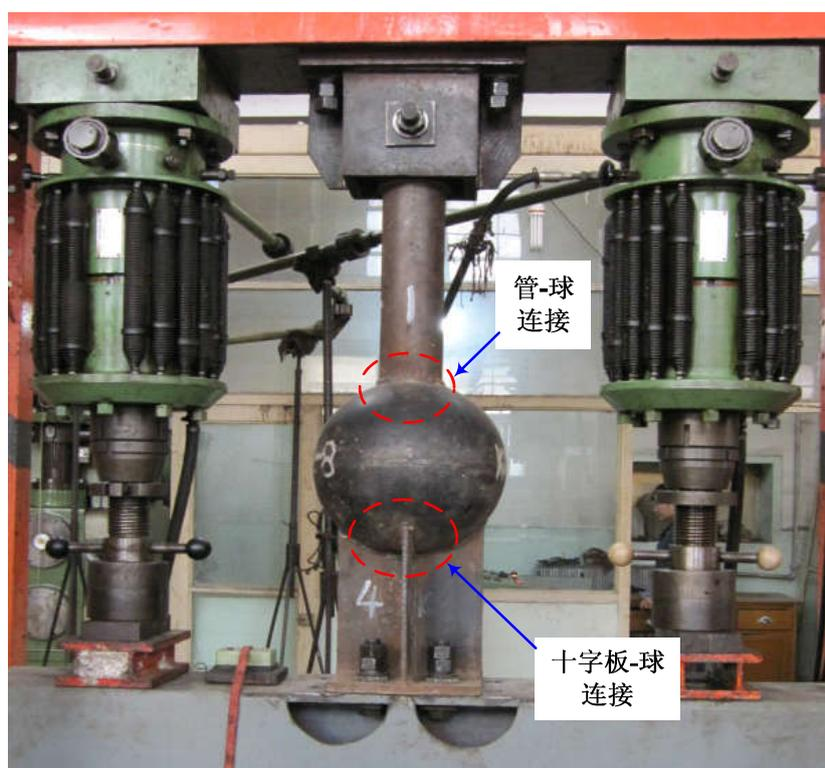
图 4-21 焊接球节点网架结构<sup>[277]</sup>
