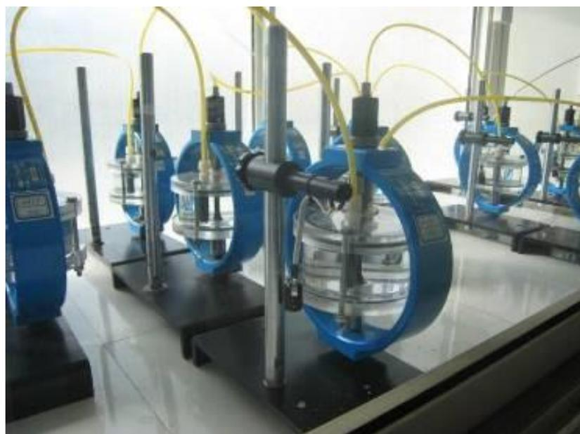
图 2-2 应力环加载应力腐蚀试验装置
