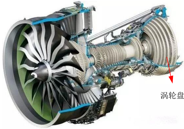
图 3-4 航空发动机涡轮盘示意图
